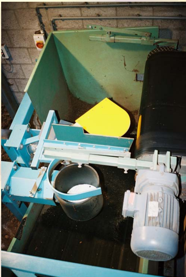
La pelle jaune prélève des échantillons sur la bande et les verse dans le cylindre de mesure CEN noir (à fond blanc).
