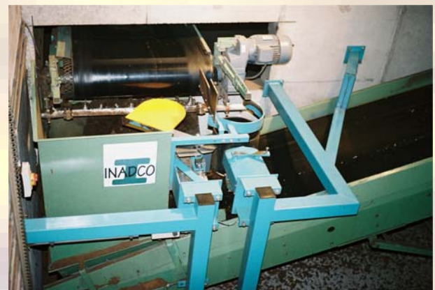
La pelle jaune prélève des échantillons sur la bande et les verse dans le cylindre de mesure CEN noir (à fond blanc).
